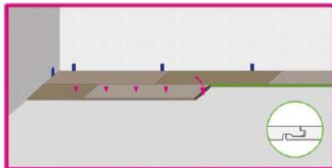
6. Procedere nella stessa maniera per completare l'installazione fino al raggiungimento del muro sul lato opposto
